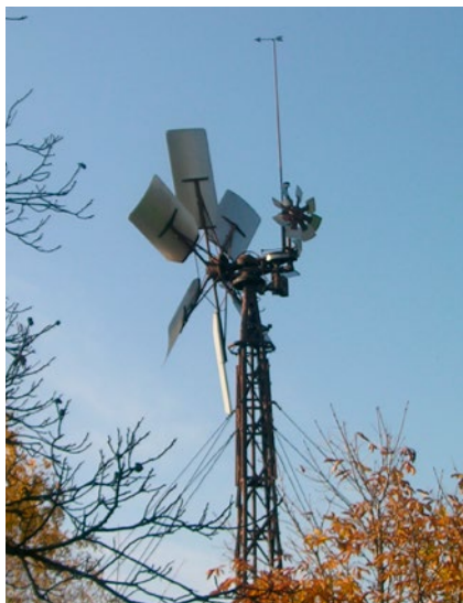
Fot. 12. Siłownia wiatrowa – konstrukcja amatorska
