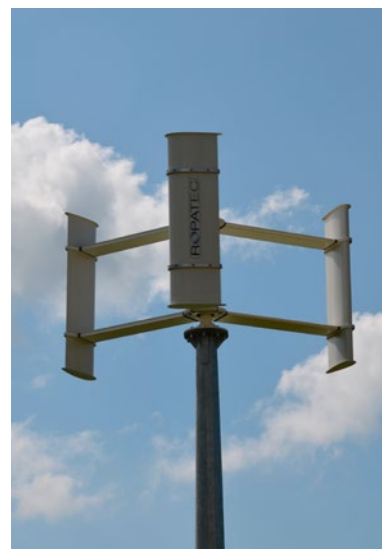
Fot. 6. Turbina typu H-rotor z pionową osią obrotu
