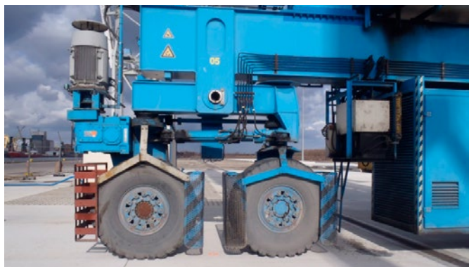
Fot. 7. Obciążenie próbne placu manewrowego suwnicą
