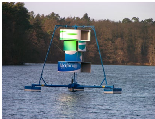
Fot. 14. Aerator z turbiną wiatrową, Szczecin, jezioro Głębokie
