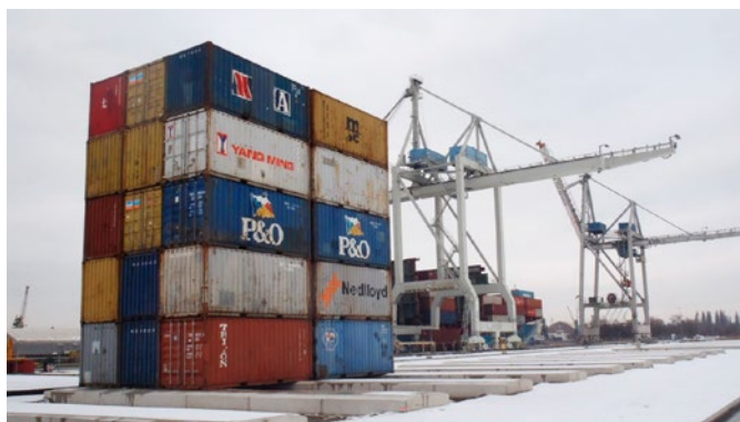
Fot. 6. Obciążenie próbne zestawem wypełnionych kontenerów, jak dla warunków użytkowania placu składowego
