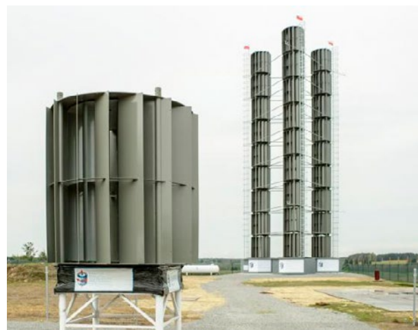
Fot. 9. Prototypowa pionowa siłownia wiatrowa firmy ProEnergetyka, Kodeń [3]
